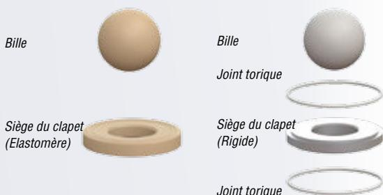
Les sièges du clapet en élastomère ne nécessitent pas de joints toriques pour sceller et sont réversibles.
