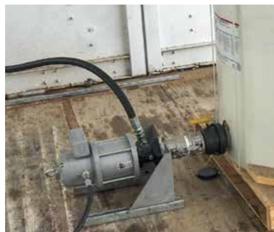
Montage horizontal pour le transfert de gros volumes de graisse
