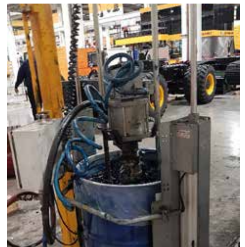
Lubrification des roulements en process de fabrication
