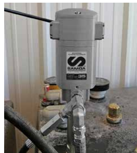
Pompe montée sur une citerne
