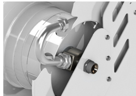
Col de cygne en 1-1/2" pour connecter le flexible et éliminer les risques d'affaissement et de pliures.
